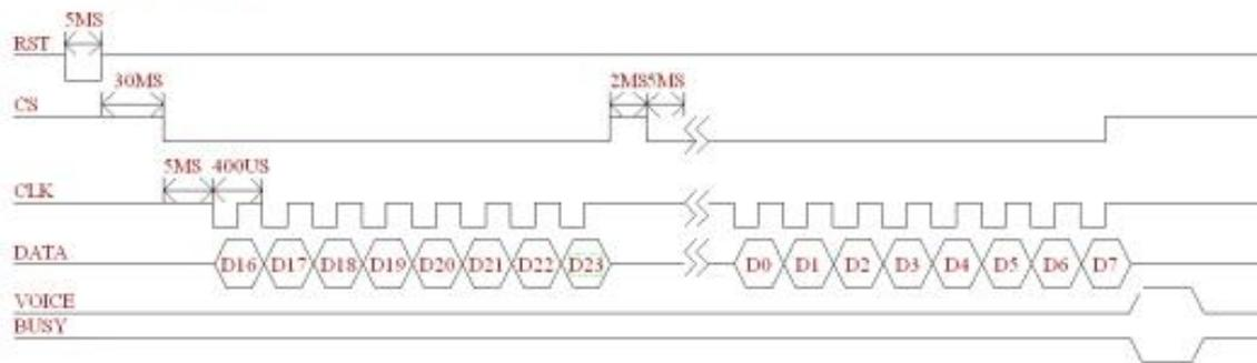
说明：先发拉低 RESET 复位信号 5ms，然后置于高电平等待时间大于 10ms（推荐使用 20ms），再将 CS 信号拉低 5ms~20ms 以唤醒语音 IC，推荐使用 5ms。接收数据低位在先，在时钟的上升沿接收数据。时钟周期介于 50us~1ms 之间，推荐使用 200us，每个字节发完后需拉高 2ms 在拉低 5ms，然后发送下一个字节。数据信号先发高字节的低位。发码完成后 CS、DATA、CLK 均要保持高电平。
