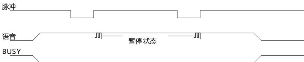
备注：负脉冲触发。控制端口检测到下降沿时（如该控制端口对地短路25ms以上）令正在播放的语音处于暂停状态，下一个下降沿触发暂停的语音从暂停点继续播放。BUSY在暂停状态一直保持。
