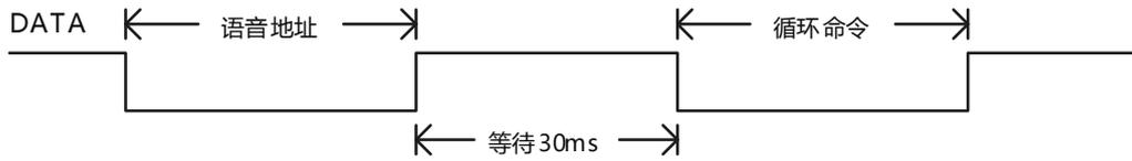
**停止播放命令 FEH**：在语音播放的过程中发送此命令可以停止播放语音，在发送 DATA 信号 1ms 之后、语音停止前发送此命令则有效。
