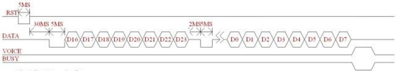
说明：先发拉低 RESET 复位信号 5ms，然后置于高电平时间大于 10ms（推荐使用 20ms），再将数据信号拉低 5ms，然后发送数据，每个字节发完后需拉高 2ms 再拉低 5ms，然后发送下一个字节。高电平与低电平数据占空比 1 : 3 即代表数据位 0，高电平于低电平数据位占空比为 3 : 1 代表数据位 1。高电平在前，低电平在后。数据信号先发高字节的低位。
