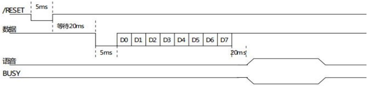
说明：/RESET 为复位信号，发数据前对芯片进行复位，如不是在特殊的工业场合，可以不使用此复位信号。在每次发送数据前，不需要都发送复位信号，直接发送命令码或者地址数据即可。DATA 为一线串口数据通信线，复位芯片稳定后先拉低 5ms 以唤醒芯片，低位在前，BUSY 为语音芯片忙信号输出，数据成功发送后等待 20ms，BUSY 输出将作出响应。数据位占空比对应详见下图。
