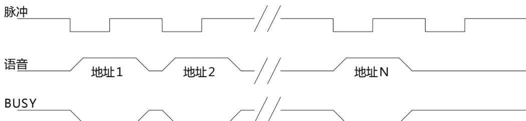
备注：负脉冲触发。控制端口检测到下降沿时（如该控制端口对地短路25ms以上）触发播放下一段语音，下一个下降沿继续触发播放下一段，触发播放完最后一段，则不会再有声音。
