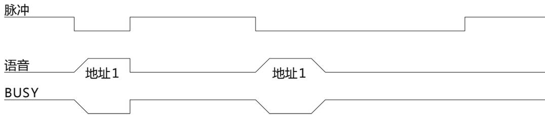
备注：低电平触发。当控制端口为低电平时，保持播放，高电平则停止。当第一遍播放结束后，还保持低电平，也不会继续播放，触发后只播放一次就结束。如果需要重新播放，则需要让控制端口处于高电平，再拉为低电平，而后保持低电平即可。
