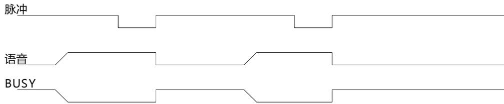
备注：负脉冲触发。控制端口检测到下降沿时（如该控制端口对地短路25ms以上）令正在播放的语音停止。语音停止后再次触发无效。
