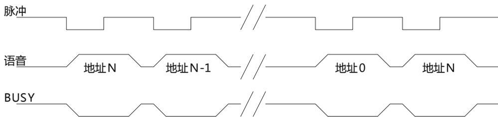
备注：负脉冲触发。控制端口检测到下降沿时（如该控制端口对地短路25ms以上）触发播放上一段语音，下一个下降沿继续触发播放上一段语音，重复操作，播放完最前一段语音，则会点播到最后一段语音，如此循环触发播放语音。
