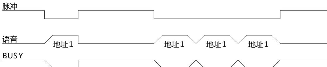
备注：低电平触发。当控制端口为低电平时，保持播放，高电平则停止。当第一遍结束后，还保持低电平，则继续重新播放，直到转变为高电平才停止。只要是低电平，则有声音；高电平，则没声音。
