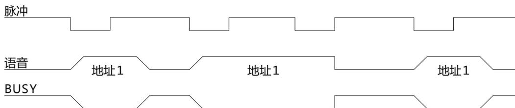
备注：负脉冲触发。控制端口检测到下降沿时（如该控制端口对地短路25ms以上）开始播放，下一个下降沿结束放音。不管声音是处于播放还是停止状态，都遵照这个规则。
