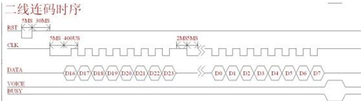
说明：先发拉低 RESET 复位信号 5ms，然后置于高电平等待时间大于 10ms（推荐使用 20ms），再将 CLK 信号拉低 5ms~20ms 以唤醒语音 IC，推荐使用 5ms。接收数据低位在先，在时钟的上升沿接收数据。时钟周期介于 50us~1ms 之间，推荐使用 200us，每个字节发完后需将 CLK 拉高 2ms 再拉低 5ms，然后发送下一个字节。数据信号先发高字节的低位。发码完成后 DATA、CLK 均要保持高电平。
